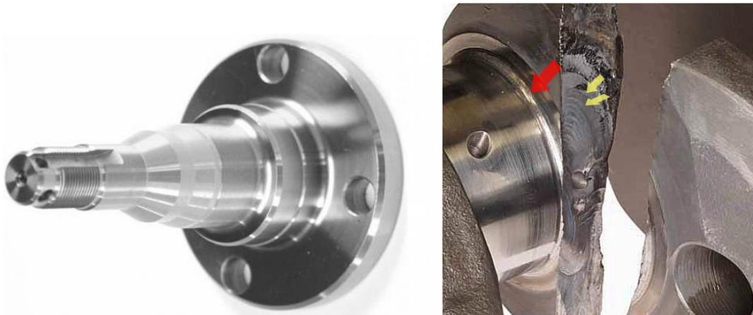
**Figura 1 – (a) Ponta de eixo do VW Gol (b) Virabrequim que falhou por fadiga na região do entalhe (fonte: <http://www.autopecasemgeral.com.br>).**
