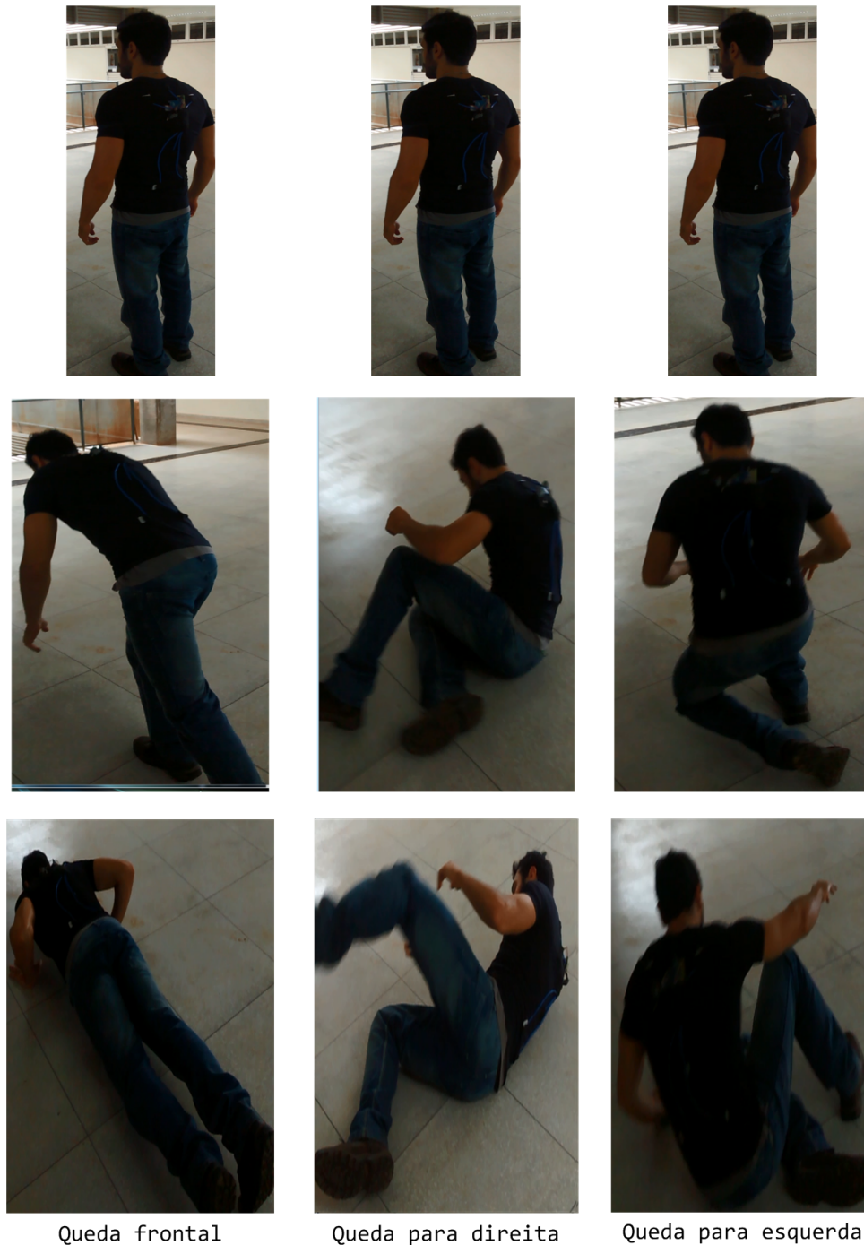
Figura 3.11. Imagens de experimento simulando quedas com o protótipo. Na primeira sequência de imagens, da esquerda para direita, está a posição inicial e mais dois instantes da simulação da queda frontal. Na segunda sequência está a posição inicial também e mais dois instantes da simulação de queda para a direita da pessoa e na terceira sequência está a posição inicial e mais dois instantes para o caso de queda para o lado esquerdo.
