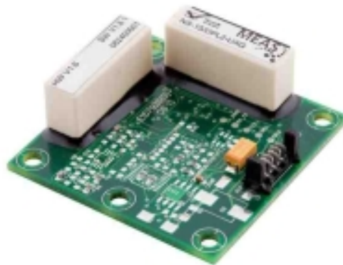
Figura 2.5. Este sensor é um exemplo de inclinômetro eletrônico da Measurement Specialties para dois eixos e medem variação de ângulos entre 2^\circ e 30^\circ . Fonte: [32]
