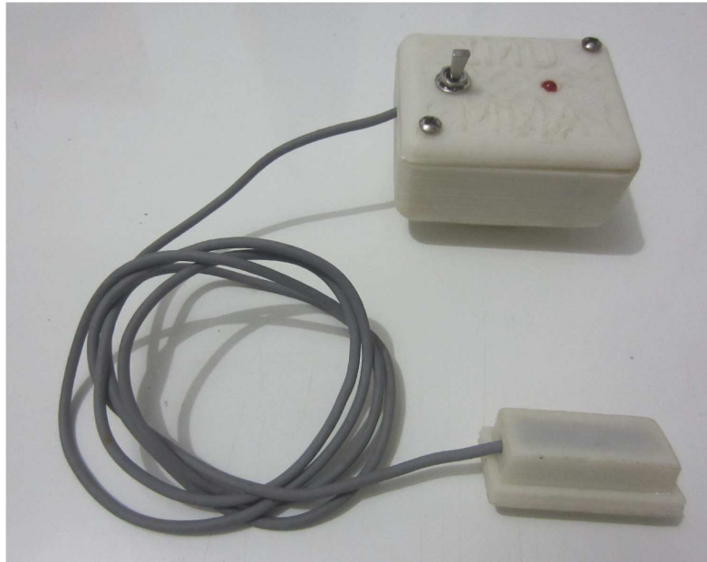
Figura 20 – Unidade de aquisição e transmissão de sinais composta por arduino (caixa grande) e IMU (caixa pequena) (LEITE et al., 2014)
