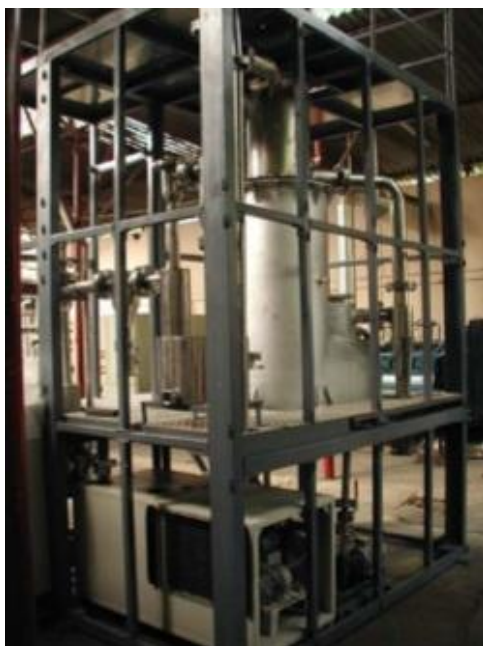
Figura 17. Gaseificador utilizado para a produção de gás de síntese, que irá abastecer os motores para a geração de energia elétrica (APOLINÁRIO, 2004).
