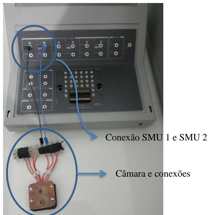
Figura 12. Esquema de conexão do sistema para testes em nanosensores e o Equipamento de Caracterização Elétrica Agilent B1500A™. As análises foram realizadas para pares de trilhas individuais.
