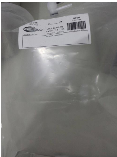
Figura 16. Bolsa para coleta de gases de 5L SKC™ utilizada para a coleta do biogás – ETE Paranoá.
