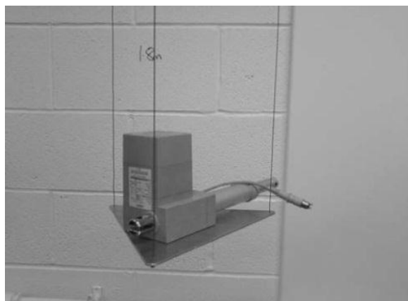
Figura 2.4 – Um atuador sobre uma placa de suspensão trifilar. (Du Bois, 2007)
