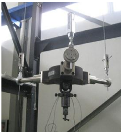
Figura 2.3 – Modelo mais complexo e moderno de suspensão trifilar, geralmente para maiores dimensões (ex.: motores). (Du Bois, 2007)
