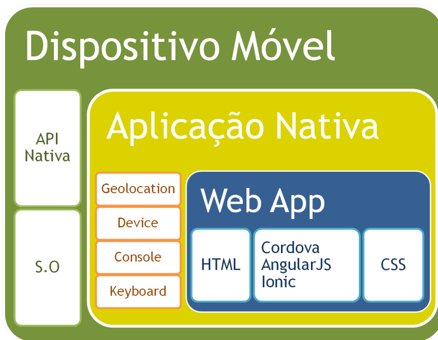
Figura 5 – Arquitetura do framework Apache Cordova , composta pelo encapsulamento da aplicação web em uma aplicação nativa instalada no dispositivo móvel. Fonte: Autor baseado na documentação oficial de The Apache Software Foundation (2013) .
