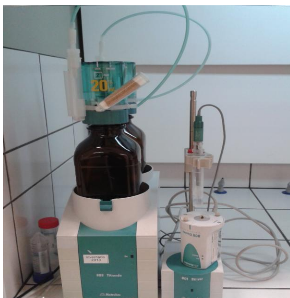
Figura 8- Titulador potenciométrico utilizado nas análises químicas de acidez. Fonte: Autora.
