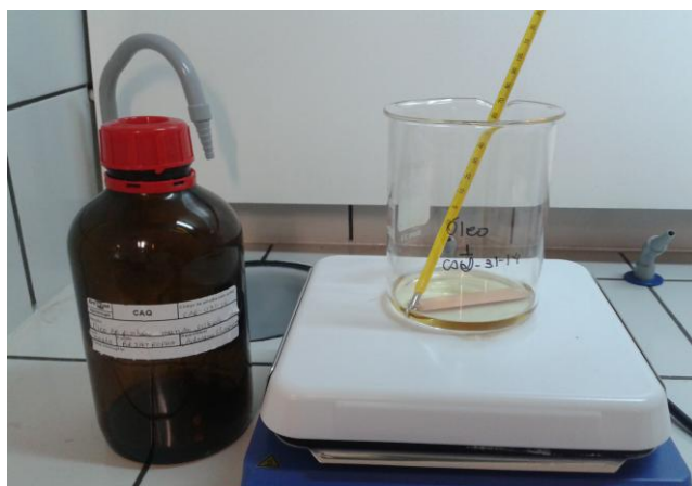
Figura 10. Oxidação na lâmina de cobre.
