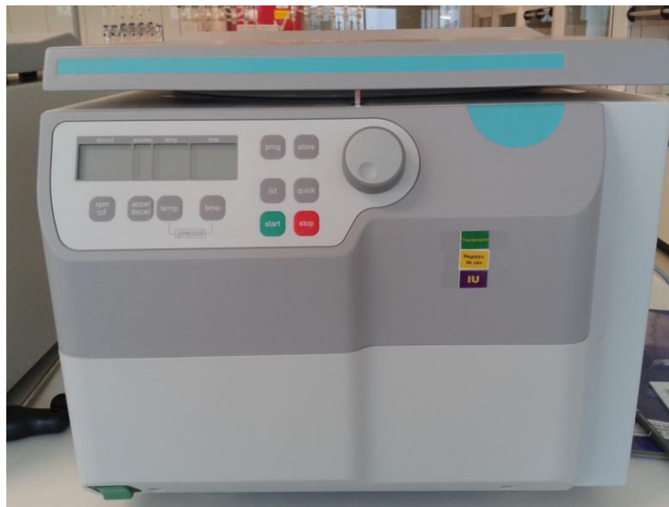
Figura 13- Centrifuga utilizada na separação do biodiesel. Fonte: Autora.
