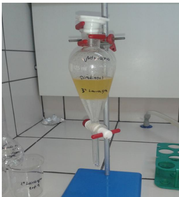
Figura 14- Separação do biodiesel. Fonte: Autora.
