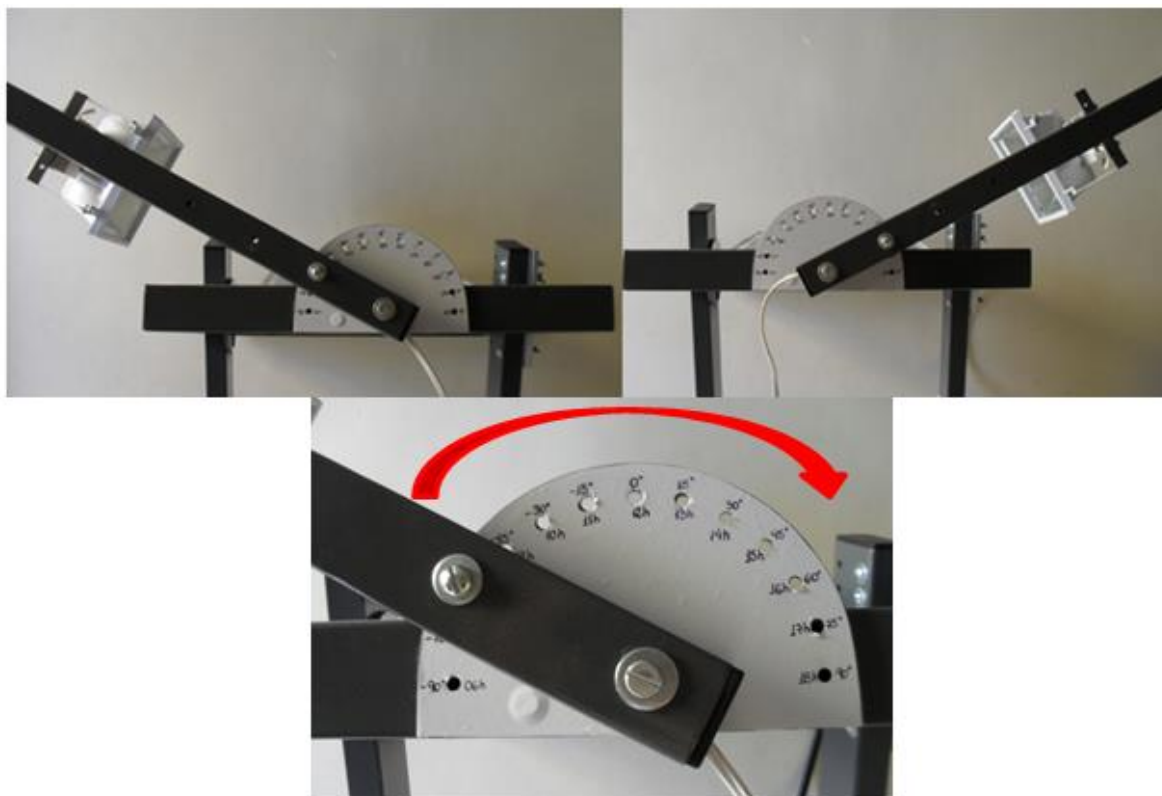
Figura 18 – Imagem do ajuste da estrutura para simular o Sol ao longo do dia das 6 às 18 horas.
