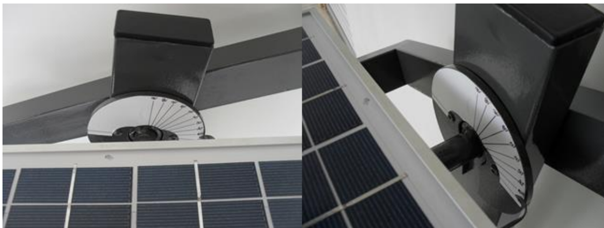
Figura 17 – Imagem do ajuste da placa solar fotovoltaica de acordo com a latitude.
