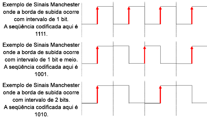
Figura 4.5: Diferentes posições para a borda de subida na codificação Manchester
