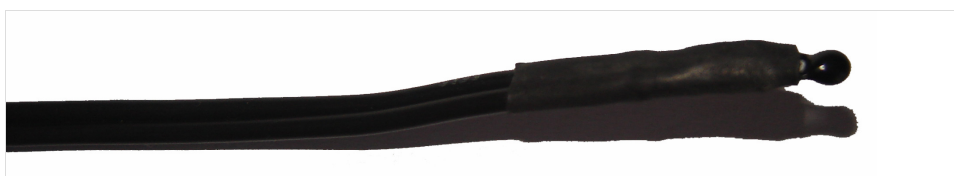
Figura A.6: Cabos e termistor para a medição da temperatura.
