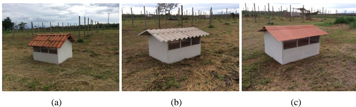
Figura 3. Imagens coletadas durante a preparação dos modelos: (a) modelo a campo com telha de cerâmica; (b) modelo a campo com telha de fibrocimento; (c) modelo a campo com telha de PVC.
