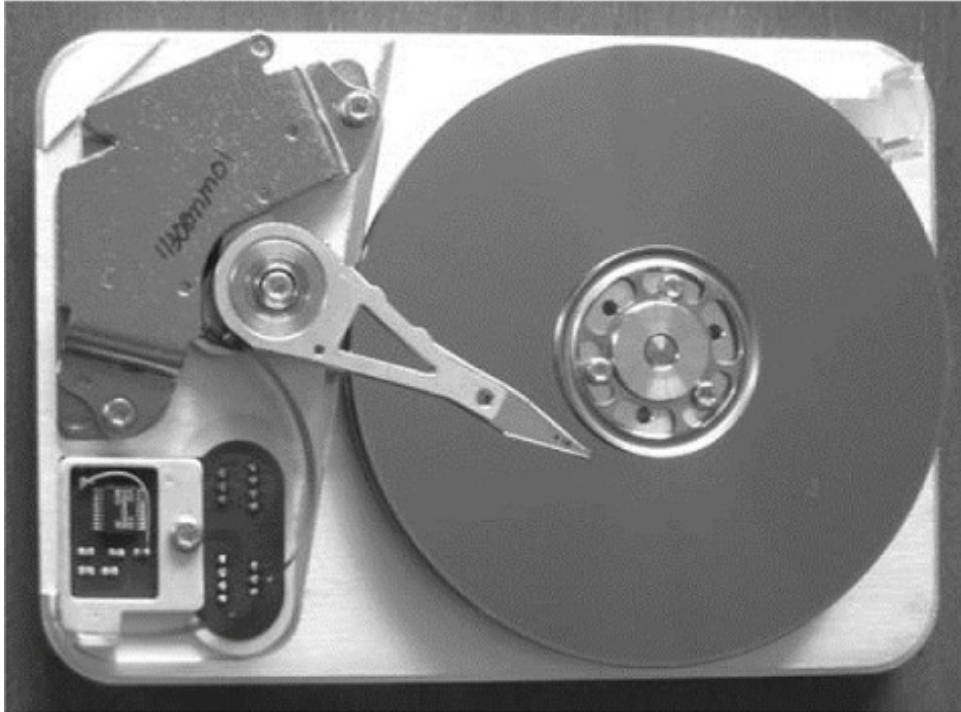
Figura 2.1: Parte interna de um disco ATA. Na direita estão os pratos e na esquerda o braço de leitura e escrita. Fonte [1]
