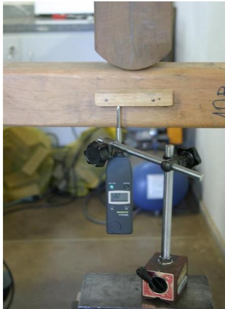
**Figura 8.** Detalhe do relógio comparador utilizado para medir as deformações
