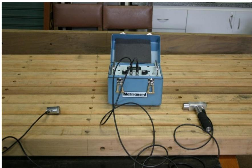
**Figura 11.** Aparelho Stress-Wave Metriguard Modelo 239 A.
