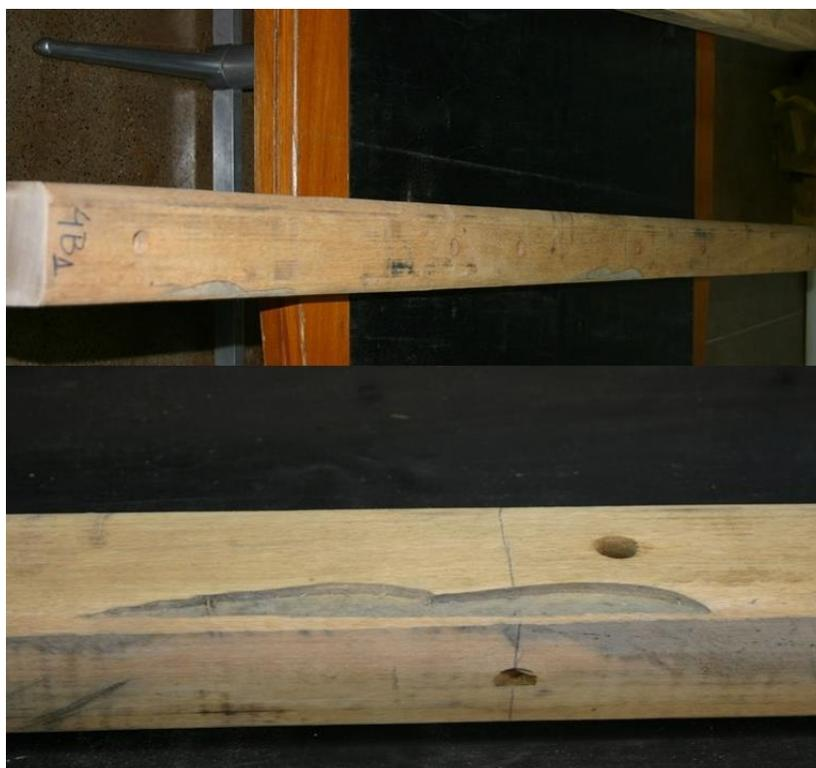
**Figura 16.** Detalhe do defeito de depressão acentuada na amostra 4
