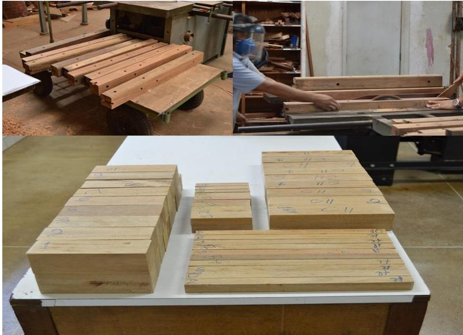
**Figura 15.** Esquema da confecção dos corpos de prova para os testes mecânicos
