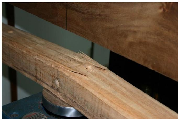
**Figura 9.** Amostra levada à ruptura na face menos resistente
