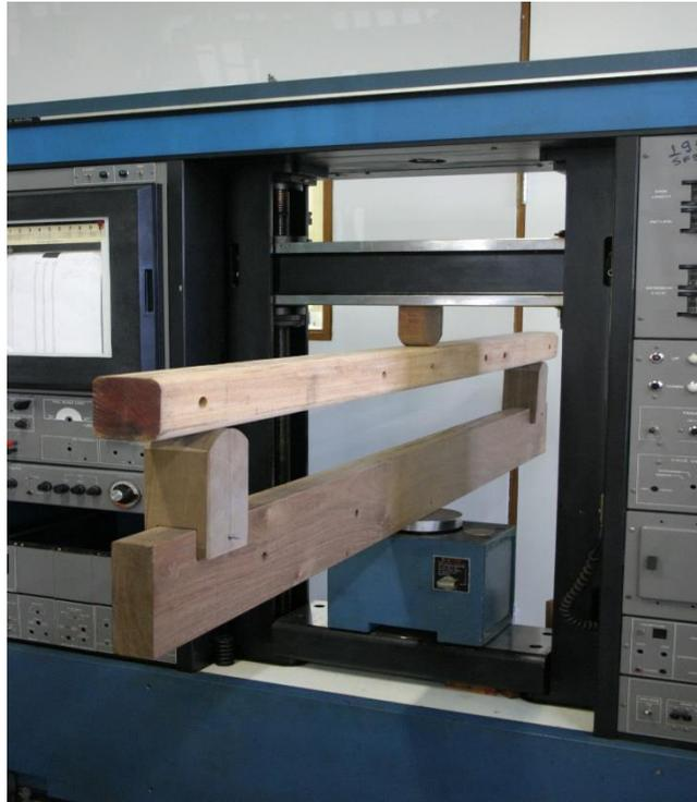
**Figura 10.** Teste de flexão estática em 3 pontos
