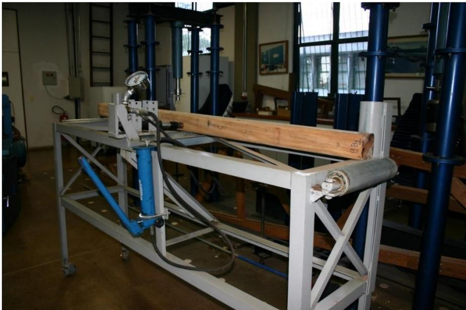
**Figura 13.** Aparelho de classificação mecânica desenvolvida no Laboratório de Produtos Florestais (LPF).
