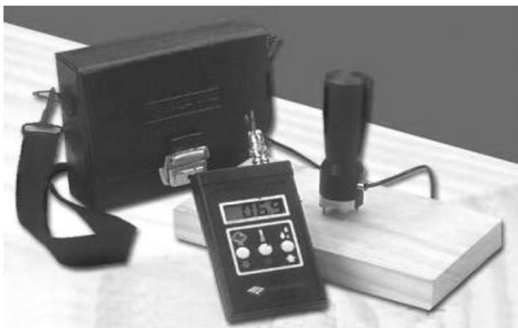
**Figura 3-1.** Medidor elétrico de umidade DYGYSTEM – Modelo DL 2000.
