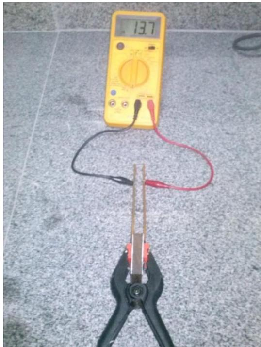
**Figura 4-3:** Capacitor construído para coleta da capacitância.
