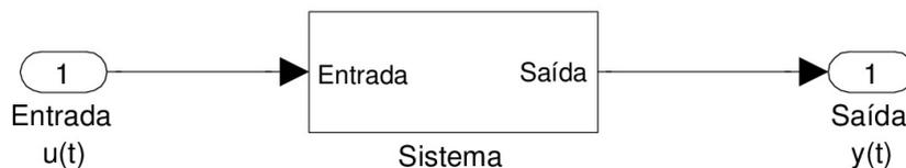
Figura 1.1: Ilustração de sistema de malha aberta.
