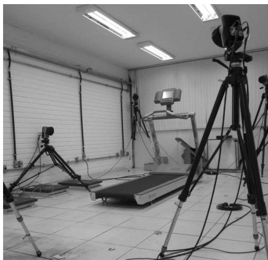
Figura 70: Posicionamento das câmeras e da esteira durante os testes.
