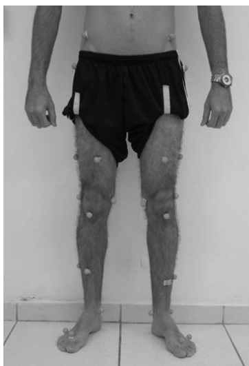
Figura 39: Disposição dos marcadores frontais utilizados nos testes.
