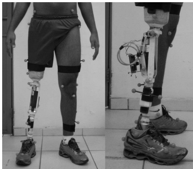
Figura 69: Marcadores utilizados para identificação da marcha com indivíduo usando a prótese do LARA.
