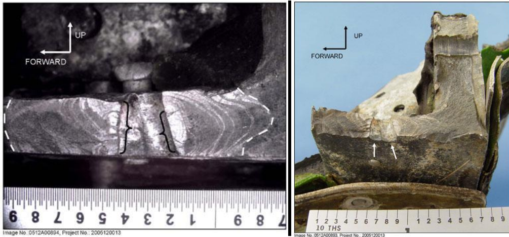
2-2 Trinca que se propagou numa longarina da asa de um avião
