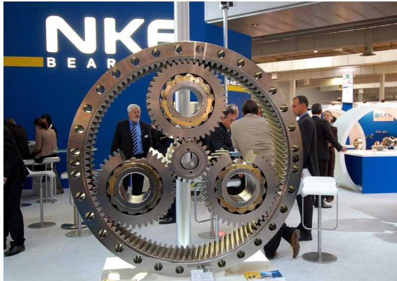
Figura 2.10 - Trem de engrenagens planetárias (NKE, 2010).
