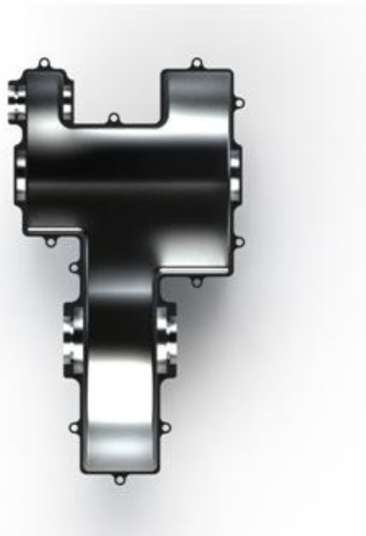
Figura 6.2 - Vista superior da base inferior da caixa.
