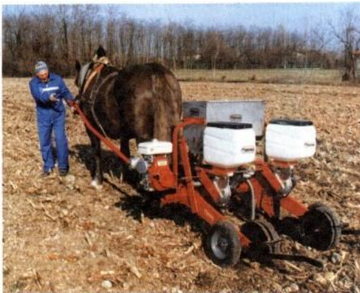
Figura 08- Máquina agrícola de tração animal.
