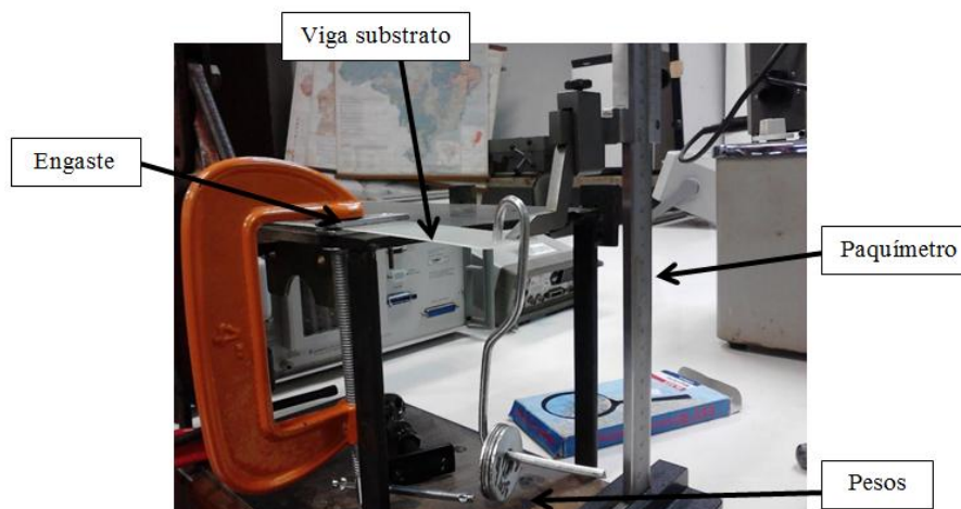
Figura 5.1 - Procedimento experimental para determinação do módulo de elasticidade.
