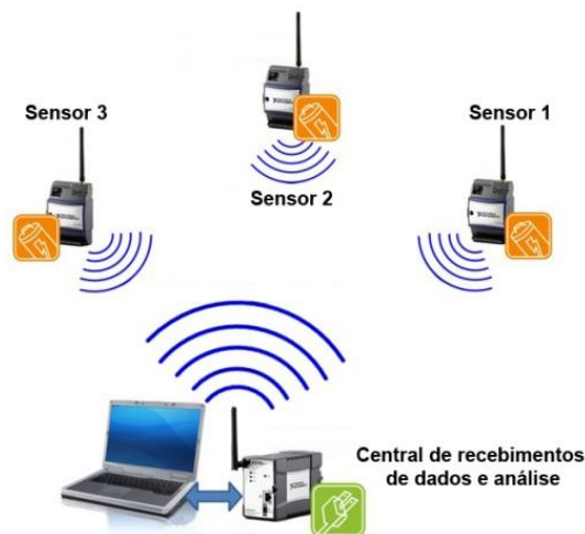
Figura 3.1 - Esquema de funcionamento de redes sem fio. Fonte: NI WSN Link Quality Logger adaptada.
