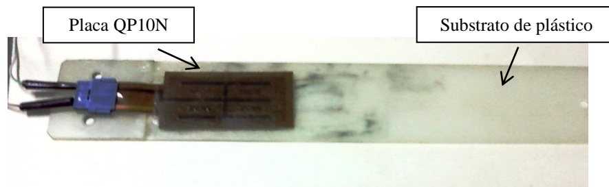
Figura 2.8 - Viga de PZT.
