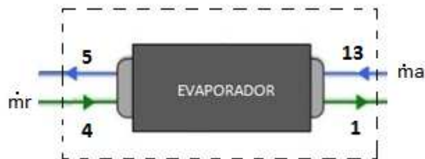
Figura 4.1. Volume de controle do evaporador.
