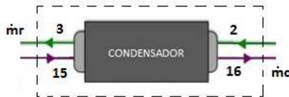
Figura 4.3. Volume de controle para o condensador.
