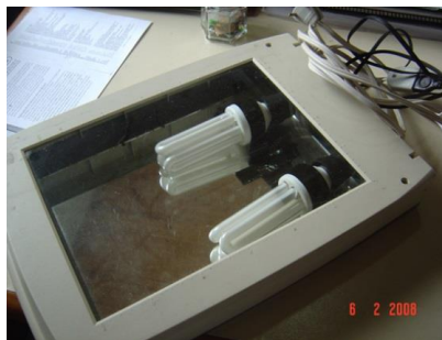
Figura 48: Mesa de luz construída manualmente.
