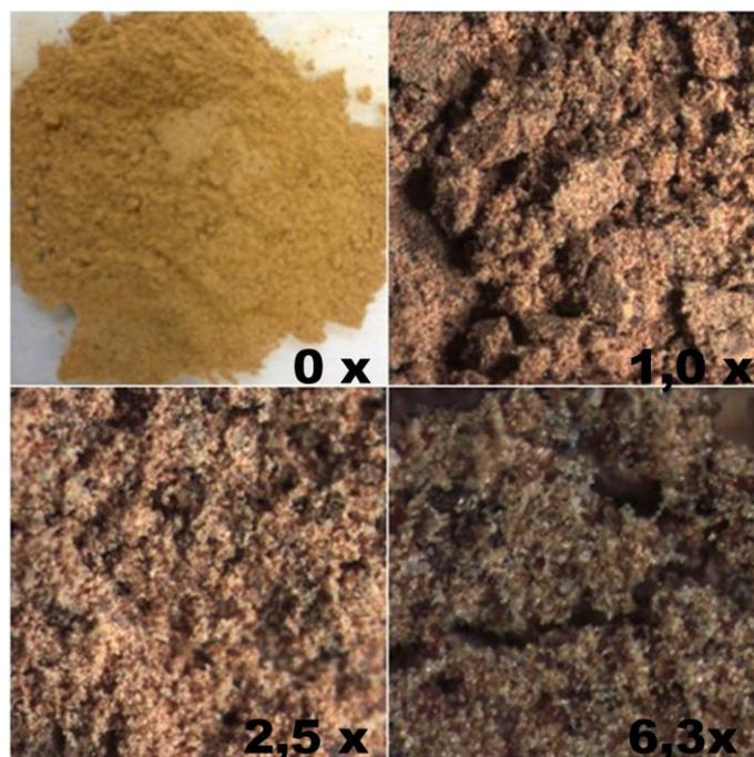
**FIGURA 11** - Avaliação da inspeção visual a olho nu e na lupa estereoscópica (Zeiss Discovery V8) no aumento de 1,0; 2,5 e 6,3x da amostra 10.
