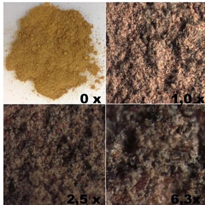
**FIGURA 7** - Avaliação da inspeção visual a olho nu e na lupa estereoscópica (Zeiss Discovery V8) no aumento de 1,0; 2,5 e 6,3x da amostra 6.
