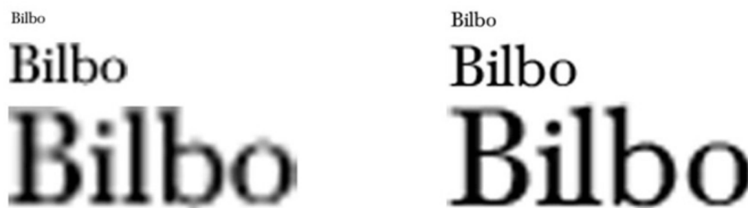
Figura 47 – Exemplo de melhoramento visual de caracteres de baixa resolução após o hinting .
