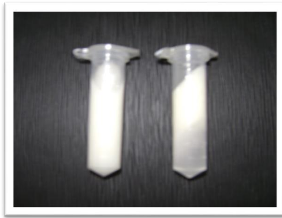
Figura 6 - Emulsões a base de óleos vegetais após processo de centrifugação, indicando ausência de qualquer sinal de instabilidade (esquerda) e cremação (direita).
