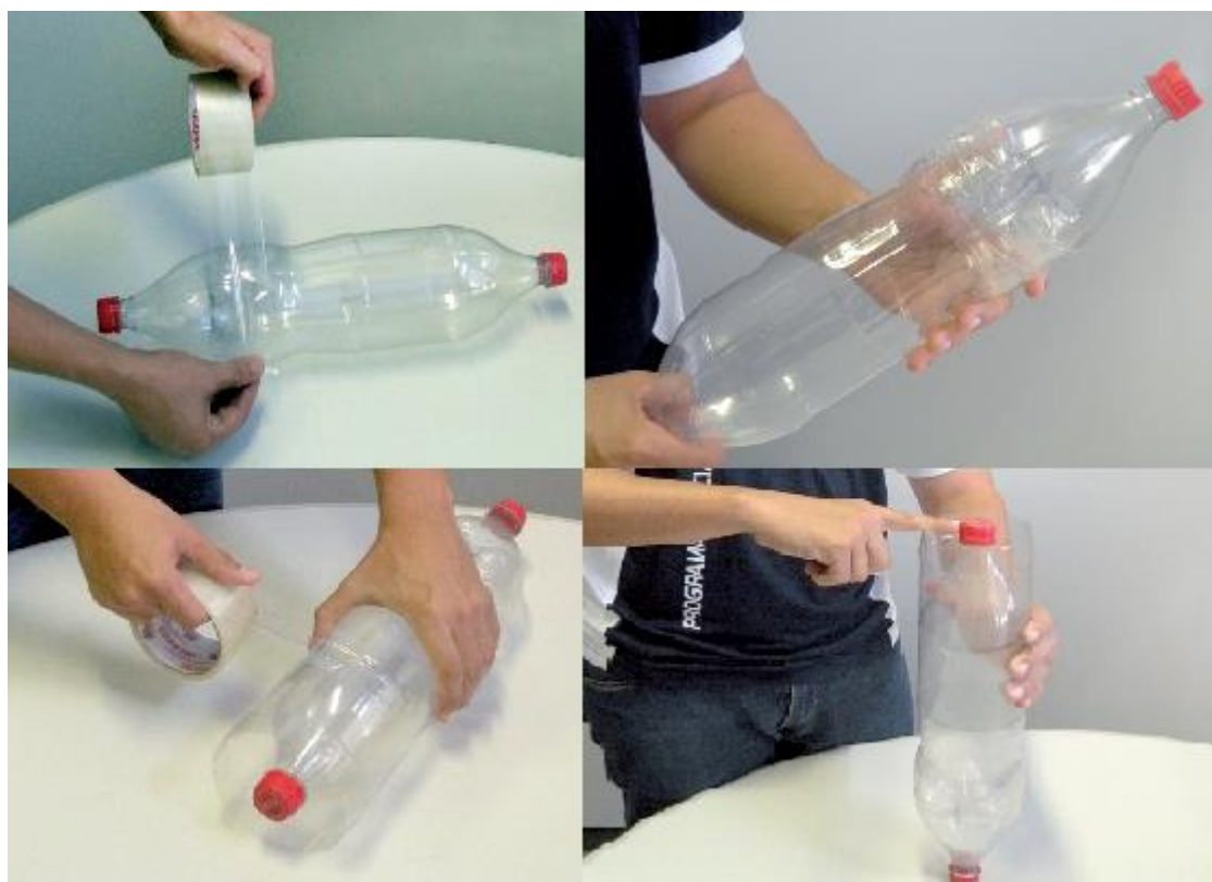
Figura 1: Garrafa cortada sendo encaixada dando origem ao bico e a base do foguete
