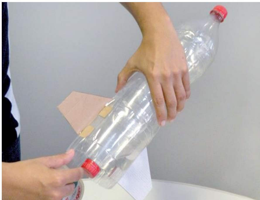
Figura 4: Fixando as aletas. Fonte: AEBEscola Mão na Massa Foguetes
