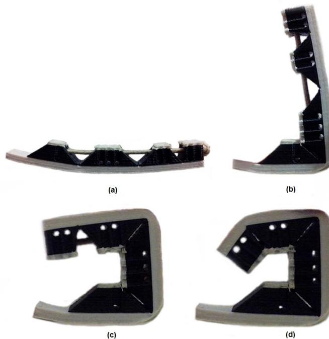
Figura 3.6: Modelo do dedo utilizado para confecção da prótese. O material preto é o plástico ABS e o branco é o plástico flexível
