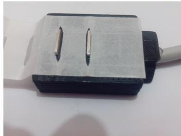
(b) cola-se um dos lados da fita no eletrodo, deixando os conectores a mostra
