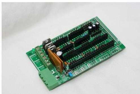
Figura 2.11: Ramps - Placa de extensão para controle de impressora 3D com Arduino . Retirado de [27]
