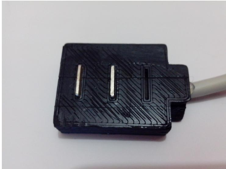
Figura 3.11: Eletrodo ativo utilizado para a captação do sinal eletromiográfico de superfície para controle da prótese
