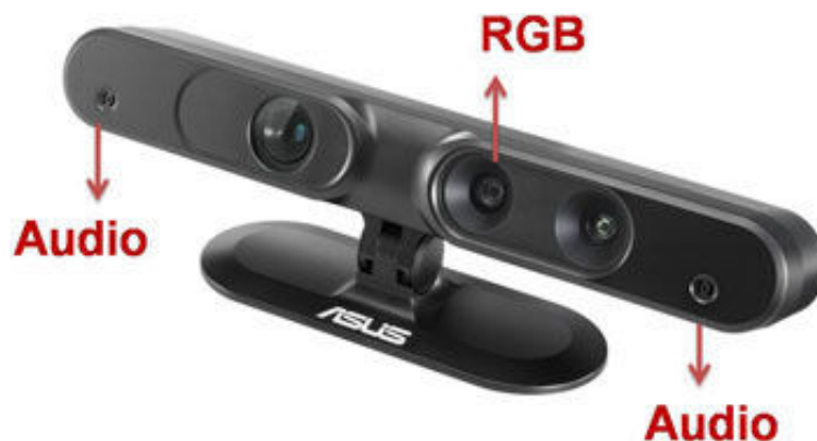
Figura 7 Estrutura do Xtion. Fonte: (ASUS, 2013)
