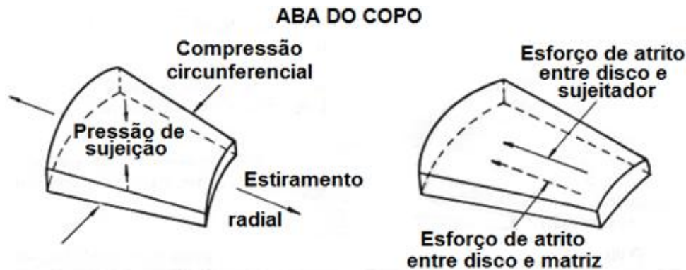
Figura 2.25 - Esforços na região da aba da peça durante a estampagem. FONTE: PALMEIRA, 2005, p. 16
