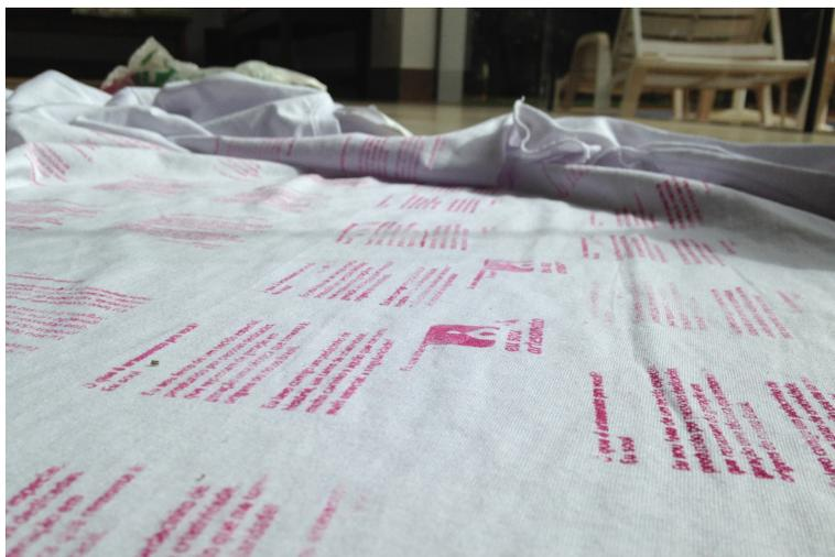
Figura 56. Testes de impressão com carimbo em malha.
