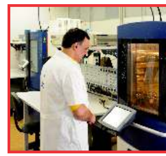
Ensaio térmico de equipamento de bordo em câmara climática
