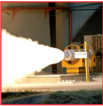
Ensaio de motor S33 em banco de provas
