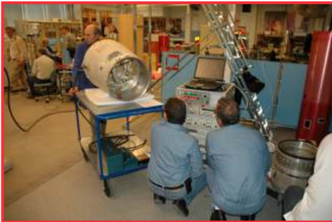
Ensaio de redes elétricas do VSB-30 (Estrange – Suécia)
