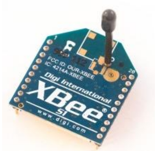
Figura 11. Módulo Xbee serie 1, fabricado pela Digi.Internacional®. [55]
