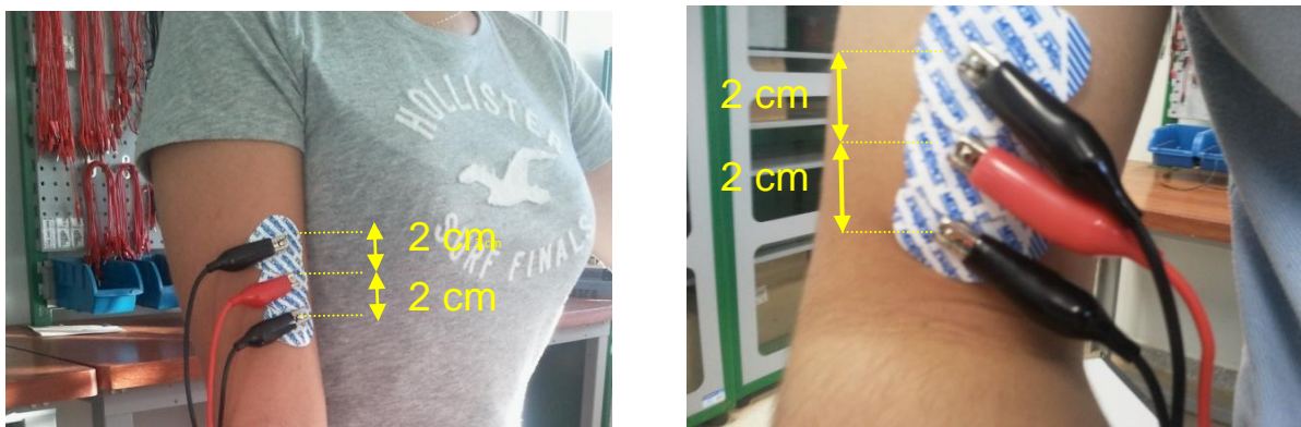
Figura 31. Eletrodos posicionados na configuração diferencial, seguindo recomendações SENIAM de distância entre os centros de 2 cm.
