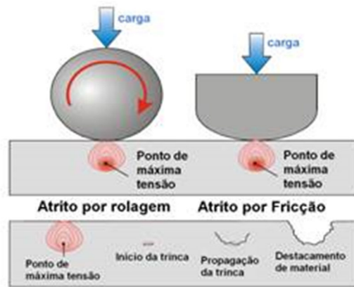
Figura 4: Desenho esquemático do desgaste por fadiga [7].
