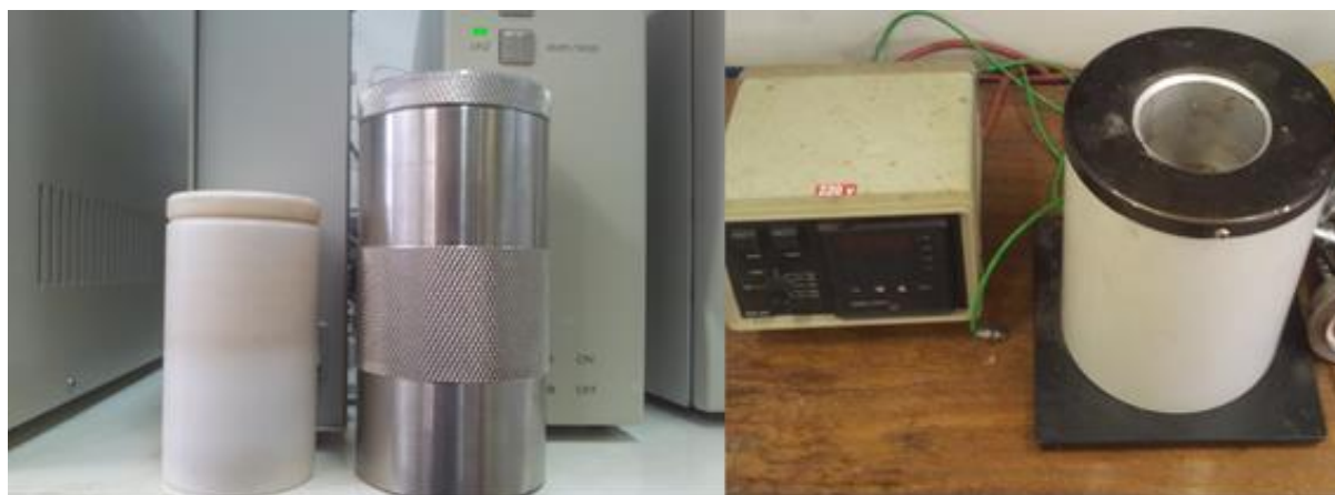
Figura 5 – Reator artesanal do Laboratório de Catálise/IQ-UnB. À esquerda tem-se a cápsula de teflon junto ao reator de aço inoxidável. À direita tem-se o equipamento de agitação e aquecimento.
