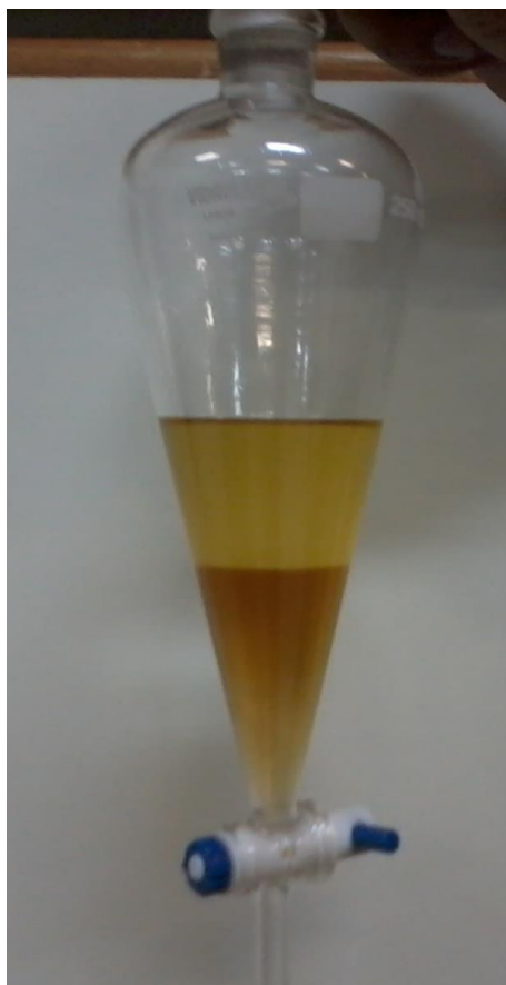
Figura 6 – Separação da glicerina (fase aquosa) do biodiesel (fase orgânica).
