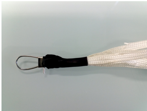
Figura 5.13: Ligação do balão e paraquedas.
