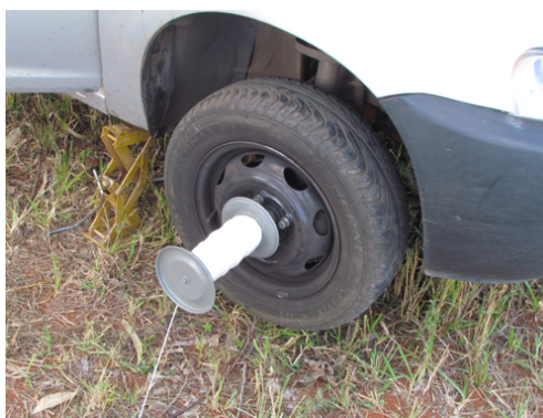
Figura 5.11: Montagem do carretel na roda suspensa.
