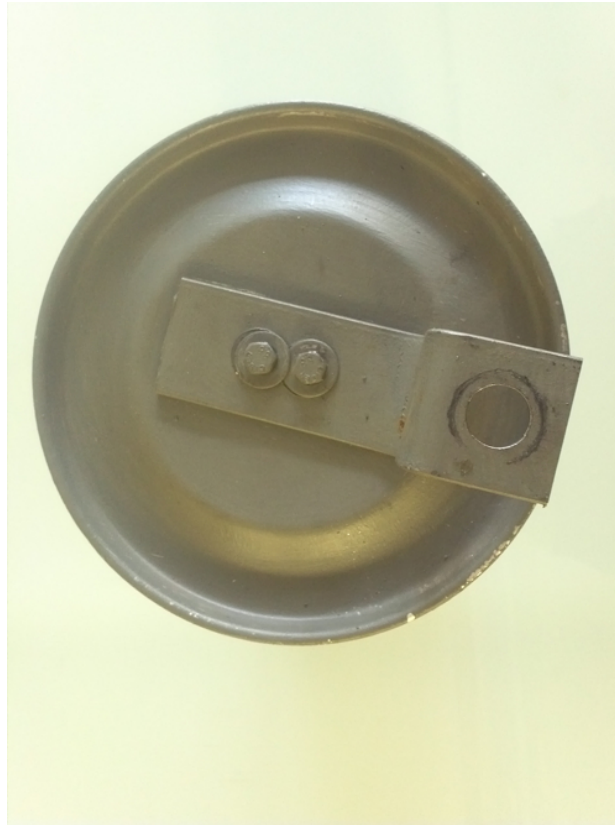
Figura 5.9: Placa que é fixada na roda do carro.
