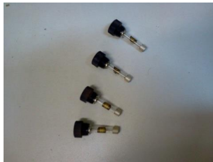
Figura 5.10 - Fusíveis do circuito elétrico da bancada (foto tirada pelo autor).
