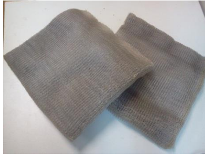
Figura 5.12 - Eliminadores de gota da bancada (foto tirada pelo autor).
