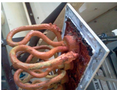
Figura 5.19 – Resistências no momento em que a caixa foi aberta (foto tirada pelo autor).
