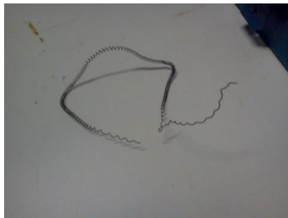
Figura 5.33 - Fio interno da resistência foi removido.
