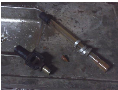
Figura 5.14 - Rotâmetro da bancada após ser limpo (foto tirada pelo autor).
