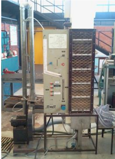
Figura 80 - Bancada experimental de torre de resfriamento – LaAR, UnB.
