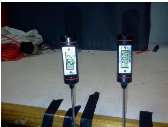
Figura 5.51 - Termômetros do psicrômetro antes do início do teste. Temperatura de bulbo seco igual 20,2°C e temperatura de bulbo úmido igual a 20,2°C.
