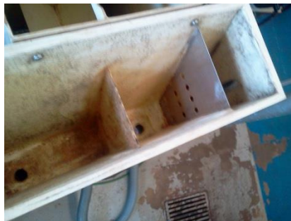
Figura 5.7 - Tanque de alimentação de nível constante da bancada (foto tirada pelo autor).
