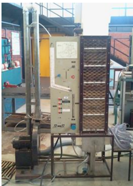
Figura 5.1 – Bancada experimental de torre resfriamento – LaAR, UnB (foto tirada pelo autor).
