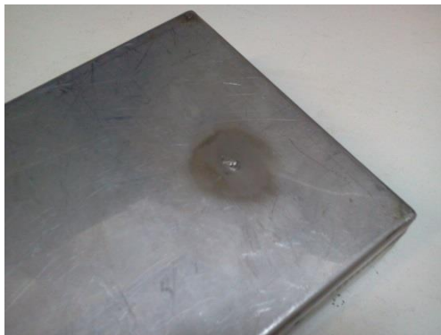
Figura 5.37 - Ponto de solda TIG no reservatório de água do manômetro.
