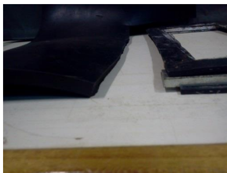
Figura 5.31 - Novo isolamento de borracha em comparação com o antigo borracha-metal-borracha.
