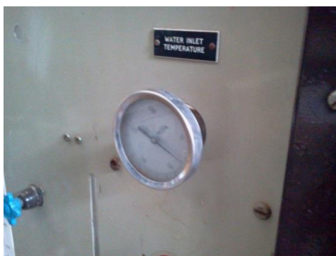
Figura 5.21 - Posição do termômetro que mede a temperatura de entrada da água (foto tirada pelo autor).
