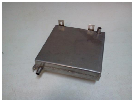
Figura 5.36 - Reservatório de água do manômetro utilizado para medir a vazão de ar.
