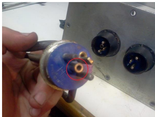
Figura 5.34 - Dispositivo de trava automático da resistência elétrica.
