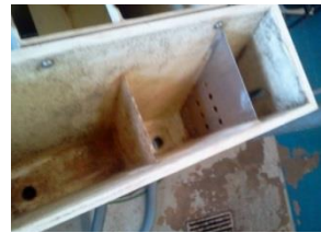
Figura 92 - Tanque de nível constante
