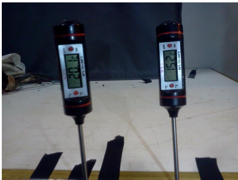
Figura 5.53 – Termômetros do Psicrômetro durante o teste quando a temperatura estabilizou. Temperatura de bulbo seco igual a 20,1°C e temperatura de bulbo úmido igual a 15,2°C.
