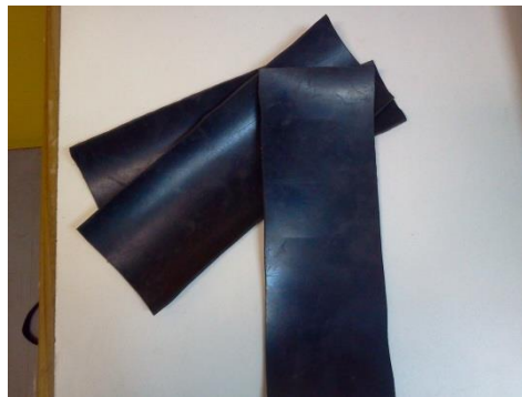
Figura 5.29 - Borracha utilizada para vedar a caixa das resistências (foto tirada pelo autor).
