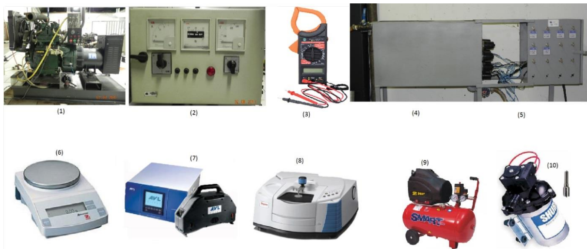
Figura 3.7 - Equipamentos utilizados:(1) Moto-gerador (2) Caixa comando do moto-gerador (3) Multímetro (4) Resistência dissipadora (5) Quadro comando das cargas (6) Balança de precisão (7) Analisador de gases (8) Espectrômetro (9) Compressor (10) Bomba de água e bico nebulizador
