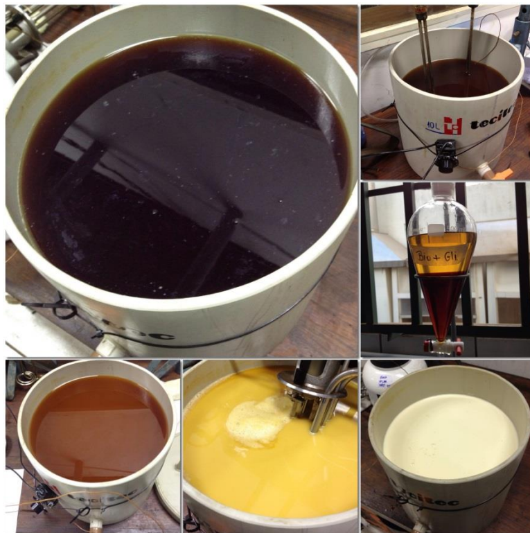
Figura 3.5 – Bancada para produção manual de biodiesel
