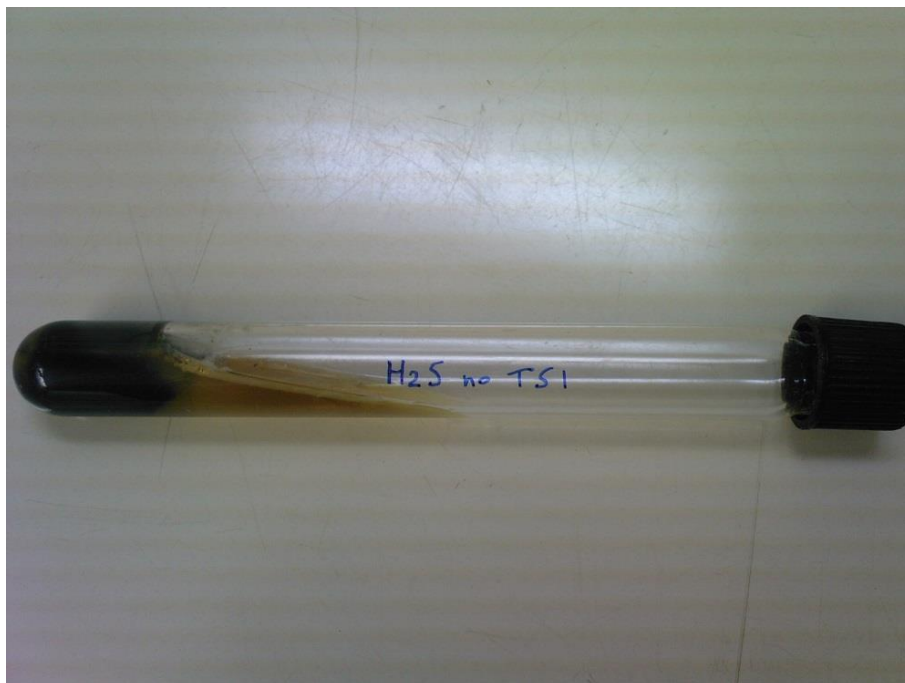
Figura 26 – Formação de H 2 S pela hidrogenação do enxofre em ágar TSI havendo a ligação aos íons ferro formando um precipitado negro.
