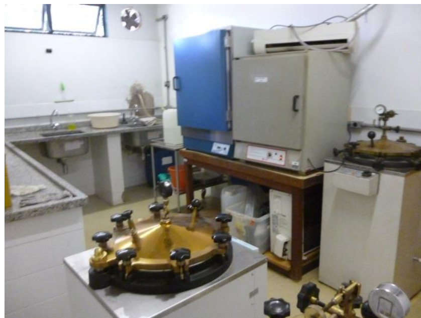
Figura 1.3 – Sala de lavagem e esterilização onde são autoclavados os materiais contaminados e os tubos que serão reutilizados.
