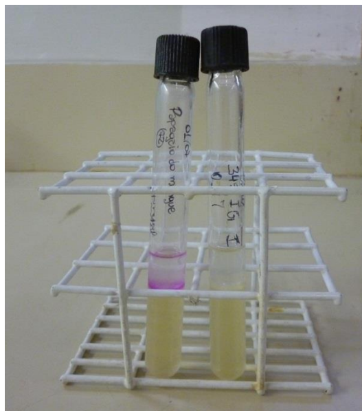
Figura 21 – O primeiro tubo mostra um resultado positivo com a formação de um anel de cor rosa abaixo da camada de éter enquanto no segundo tubo à direita o resultado se mostra negativo ocorrendo uma reação incolor.
