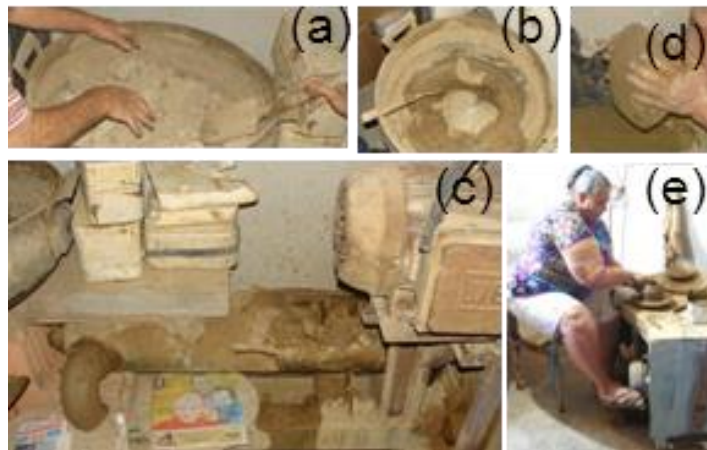
Figura 9. Processo artesanal de preparação de peças de barro moldadas: (a) mistura de britas de argilas em tachos; (b) as britas são umedecidas e ficam repousando por 24 h; (c) a mistura é homogeneizada em uma maromba; (d) uma porção do barro é separada; e (e) girando no torno, a porção de barro toma a forma desejada nas mãos ágeis da artesã Elza.
