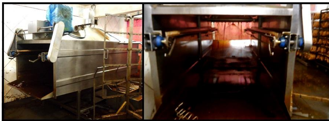
Figura 12. Máquina de defumação líquida preparada para receber as linguiças a serem defumadas
