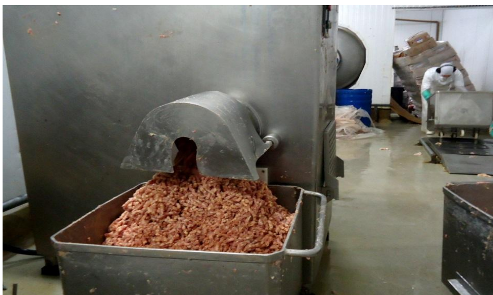
Figura 1. Retalhos magros e gordos, papada, coração e pele sendo cominuídas, numa máquina trituradora.
