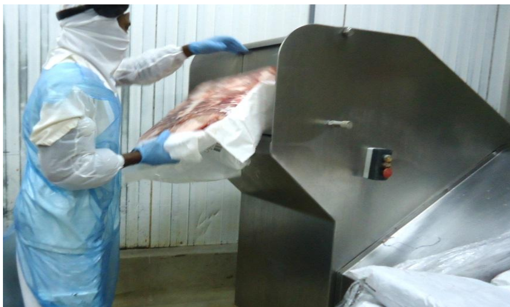
Figura 19. Funcionário colocando pernil e músculo sem gordura, na máquina trituradora
