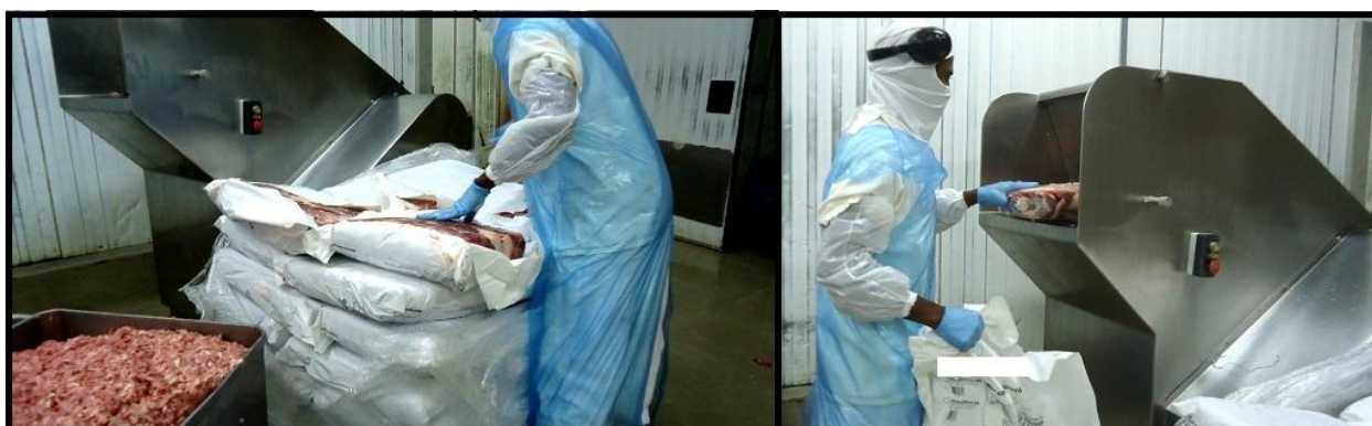
Figura 15. Funcionário colocando na máquina trituradora, os fígados suínos e CMS congelada.
