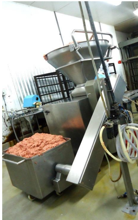
Figura 5. Massa de linguiça frescal sendo colocada na máquina embutidora
