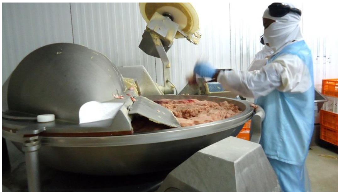
Figura 17. Funcionário adicionando ingredientes da mortadela no cutter
