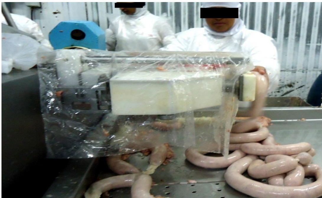
Figura 6. Funcionária realizando o embutimento da linguiça frescal
