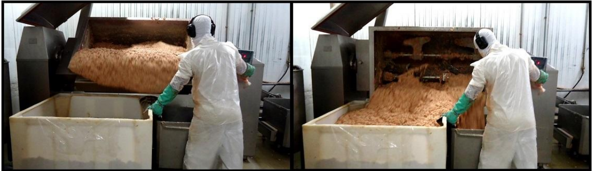
Figura 3. Na sequência da figura, a massa para linguiça frescal sendo misturada e posteriormente repassada para tanques de plástico e carrinhos de alumínio.
