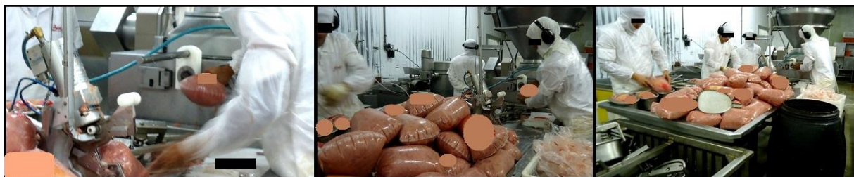
Figura 22. Na sequência da figura, os funcionários embutindo os presuntos, lacrando-os e colocando-os nas formas de inox
