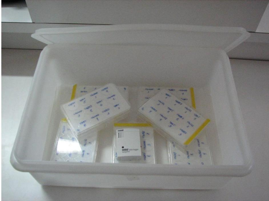
**Figura 5. Placas de Elisa incubadas sob condições controladas ( $25\pm 1^\circ\text{C}$  e  $\text{UR}>95\%$ ), com o datalogger.**
