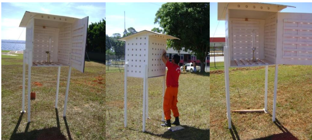
Figuras 3.1, 3.2 e 3.3: Abrigos onde foram colocados os psicrômetros convencionais utilizados para a medição dos dados. Fonte: Mamedes Luiz Melo.
