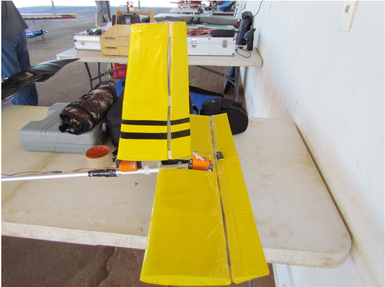
Figura IV.4: Lincagem e servo do profundor.
