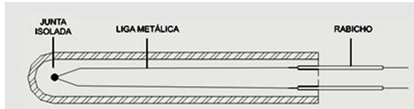
Figura 14 - Termopar encapsulado (adaptado de TermoShaw, 2012)
