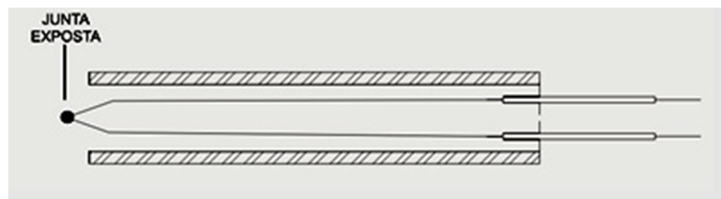
Figura 12 - Termopar de junta exposta (adaptado de TermoShaw, 2012)
