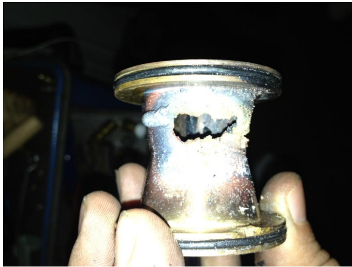
Figura A. 10 - Tubeira de cobre consumida
