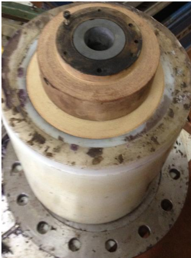
Figura A. 3 - Tubeira dentro da câmara de celeron
