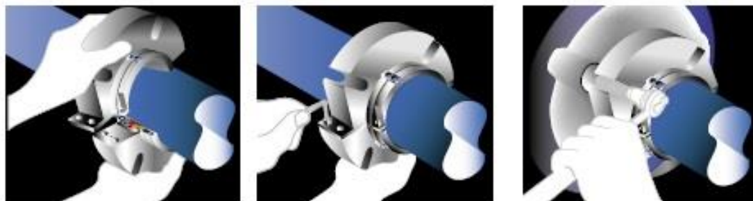
Figura 53- Esquema de montagem selo Flex-A-Seal (Fonte: Catálogo Flex-A-Seal)
