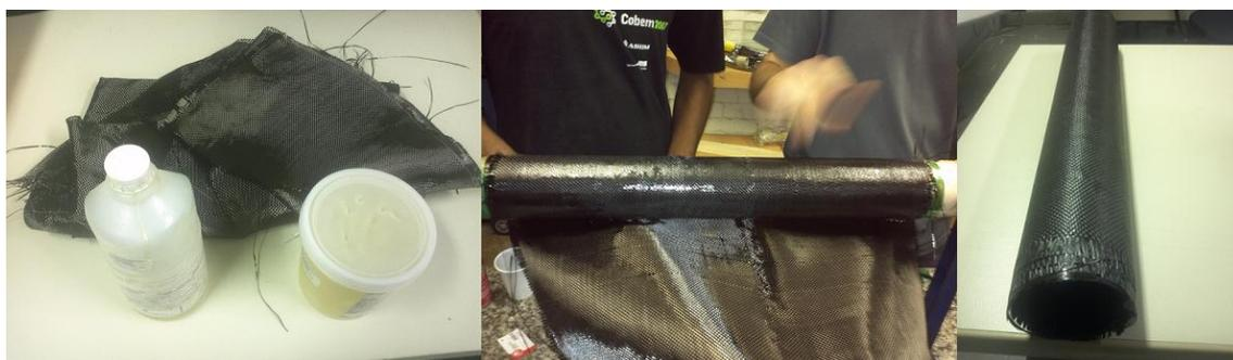
Figura 59: Laminação do tubo principal.
