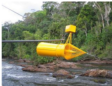
Figura 1.4: Hidrocínética Geração 2 projetada pela Universidade de Brasília. Geração de 2 kWh instalada em Correntina-BA . (Ago. 2005).
