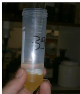
**Figura 4.** Fases da separação: parte superior metanólica e parte inferior clorofórmio e fração lipídica.
